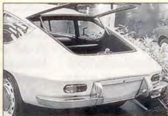
Praktisch: Große Heckklappe und separates Ersatzrad-Fach.
