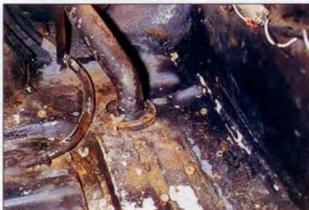
Undichte Heckscheibendichtungen machen den Kofferraum nicht selten zum Feuchtbiotop.
