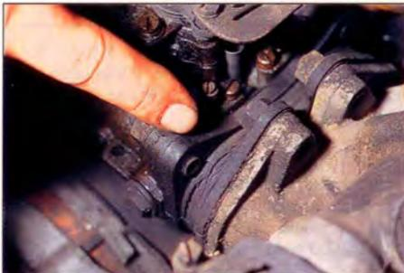
Vorsicht: Risse im Vergaserflansch sind oft der Grund für Überhitzungslöcher in den Kolben.
