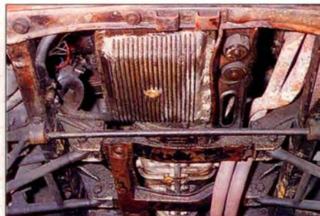
Für größere Arbeiten läßt sich der Hilfsrahmen samt Motor und Getriebe nach unten ausbauen.
