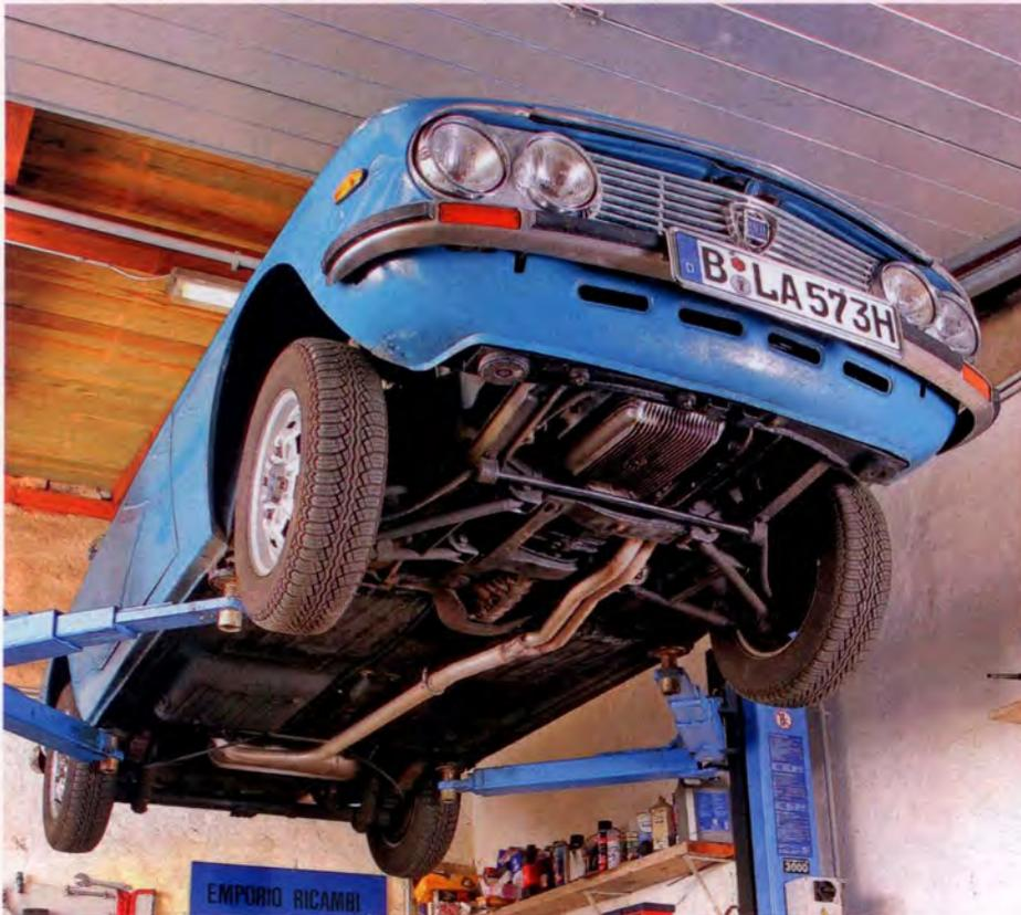
Das Detail kompliziert, die Gesamtheit durchdacht: Der Fahrschemel mit Motor, Getriebe und Vorderachse wird von sechs Schrauben gehalten – ein Fest für jeden ambitionierten Restaurierer!
