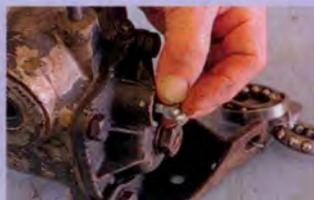
Fließfett statt Öl: So bleibt das Lenkgetriebe auf Dauer dicht
