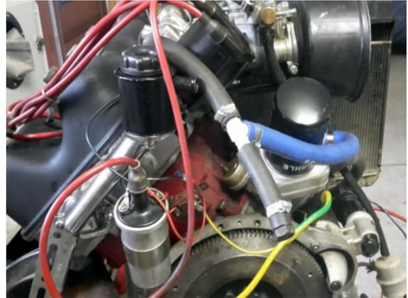
Gewinderohr auf Länge schneiden, festschweißen, Wärmetauscher mit Flachmutter befestigen. Dann den Ölfilter auf den Wärmetauscher aufschrauben. Bock mit neuer Dichtung einbauen und mit Formschläuchen und 2 T-Stücken an den inneren Wasserkreislauf des Motors anschließen:
